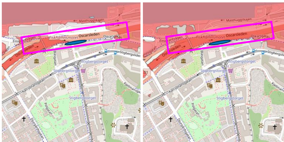
Figur 2-21 Utdrag från Vatten i staden . T.v. utbredning "Planeringsnivå hav, Byggnader och framkomlighet". T.h. "Planeringsnivå hav, Samhällsviktiga anläggningar". Hissarnas ungefärliga placering vid Oscarsleden/E45 markerad med blå oval. Magentafärgad rektangel visar ungefärlig sträckning längs älven som tillkommer med det reviderade planförslaget som tillkommit under hösten 2025.
